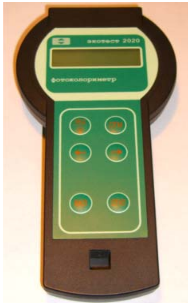
Рис. 1 — Внешний вид фотоколориметра ЭКОТЕСТ-2020
