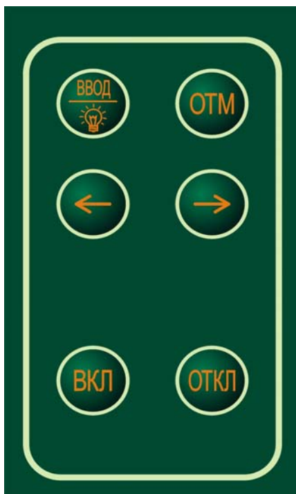
Рис. 2 — Органы управления фотоколориметра
